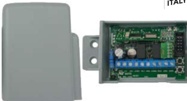
Ricevitore rolling e/o codice fisso 2 canali **CON MEMORIA ESTRAIBILE**
